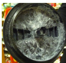
Réservoir de l'autolaveuse après utilisation de produits habituels : Dépôts et mauvaises odeurs associées
