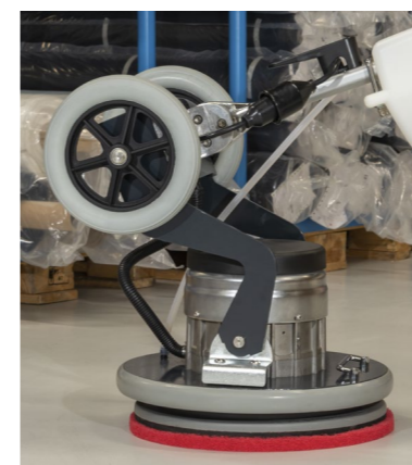
Timon inclinable pour augmenter la pression de contact.
