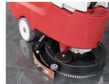
La poutre d'aspiration pivotante est accouplée au timon et tourne automatiquement dans la direction de travail dans les virages.
